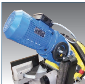
V Variatore di velocità lama Blade speed variator Variateur vitesse ruban
