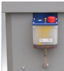
NB1/NB2 Nebulizzatore per la lubrificazione lama ad uno e due ugelli Sprayer for blade lubrication one/two nozzle Micro pulverisation pour la lubrification du ruban à un/deux buses
