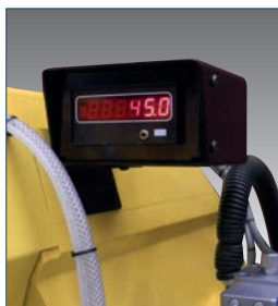
VAT Display per la visualizzazione dell'angolo di taglio Display for cutting angle viewing Afficheur pour la visualisation de l'angle de coupe.
